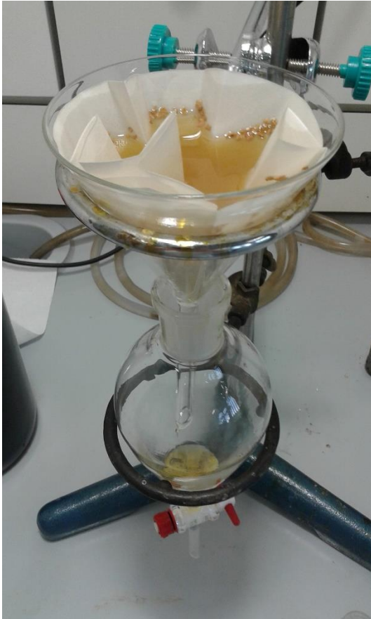
Slika 1. Filtracija vzorca po ekstrakciji trdno-tekoče v topilu etanol. Po filtraciji je sledilo odparevanje topila in koncentriranje filtrata na rotavaporju.
