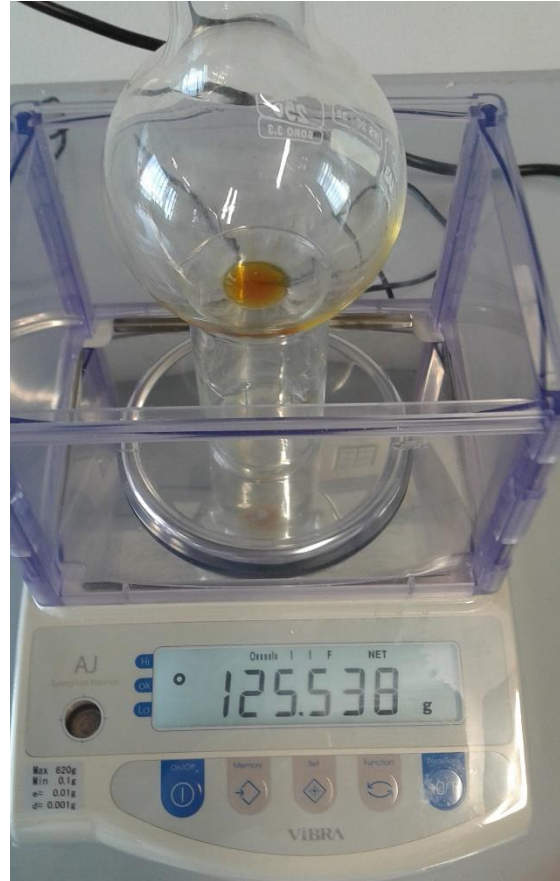
Slika 2. Ekstrakt po ekstrakciji trdno-tekoče (posušena ingverjeva pulpa – etanol) po rotavapiranju ekstrahiranega vzorca.
